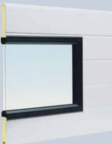
Sandwich-Verglasung mit Iso-Doppelscheiben, 16 mm k = \text{ca.} 2,85 \text{ W/m}^2\text{K}
